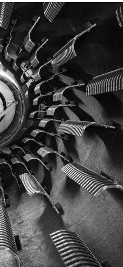
Grundlage für viele Bauprojekte der Rhomberg Bau Gruppe: das neue Asphaltmischwerk der MIGU in Lustenau. (rechts) Der Einblick in die Trockentrommel imponiert. (links)
